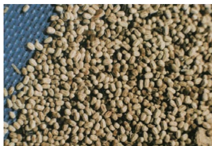
写真6-4 アメリカカンザイシロアリによって被害材から排出された糞 一宮田光男氏提供
