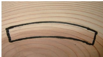
写真1-4 樽材として利用されるスギ源平材の木取り
