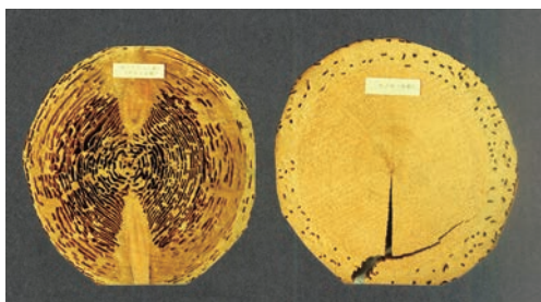
写真2-3 シロアリによって食害されたカラマツ(左)とヒノキ(右)の円盤
