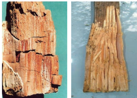
写真3-3 褐色腐朽(左)と白色腐朽(右)
