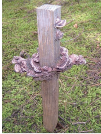
写真3-2 土中に埋められていたスギ杭から発生した子実体（腐朽はかなり進行していることを示す）
