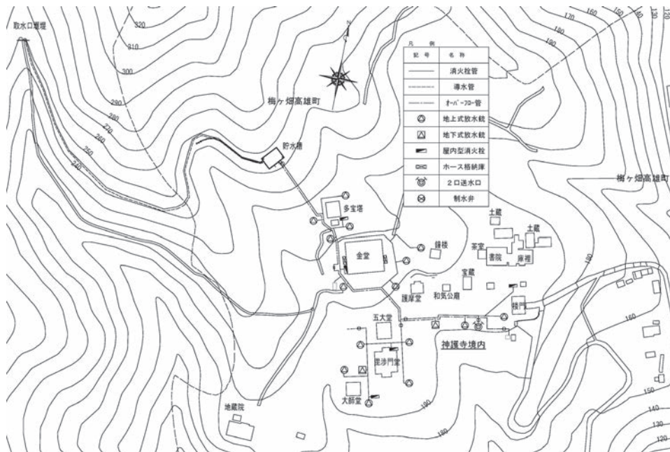
図1 境内の消火栓設備
