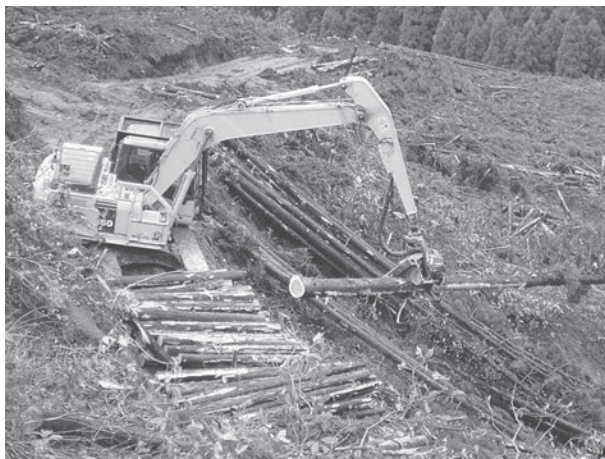
写真-2 高性能林業機械（プロセッサ）によるスギの造材（宮崎県）
