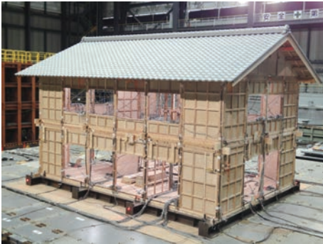
土台仕様2階建て試験体
