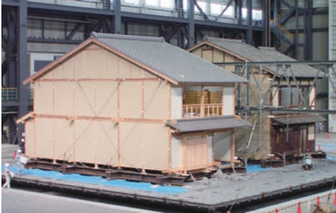
2005年度京町家実大振動台実験
