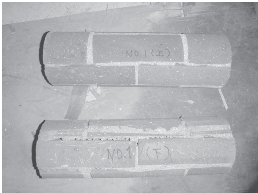
NO-1 目地部の施工状況がよく見られる
