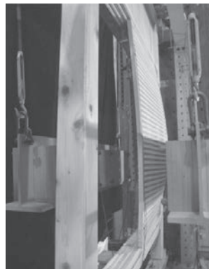
図12 舞良戸の面外座屈 (試験体B -1/15rad)
