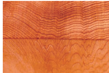
写真12-6 春日杉の笹杵の出現 （上：木口面、下：板目面）
