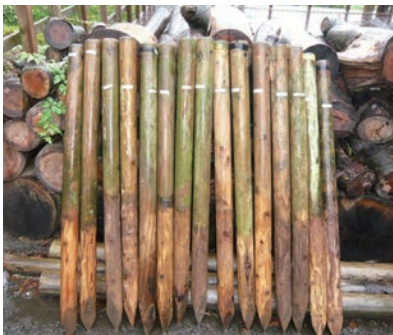
写真9-3 加圧注入処理した遊歩道ロープ支柱 (スギ丸太：φ=70mm、L=1200mm) の13年経過後の様子 —日本木材防腐工業組合提供—
