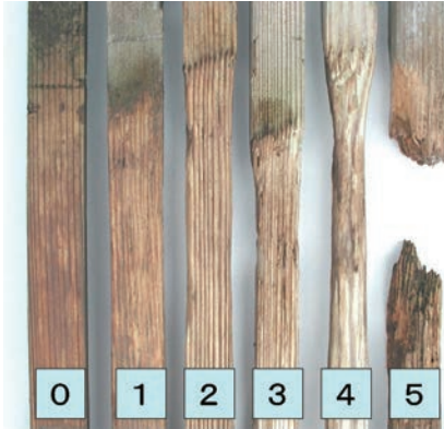
写真9-2 野外防腐試験での被害度の例 —酒井温子氏提供—
