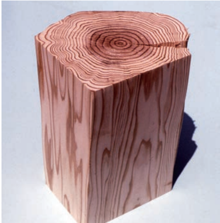
写真15-4 天然シボスギの 木口面（上部）と縦断面（下部）
