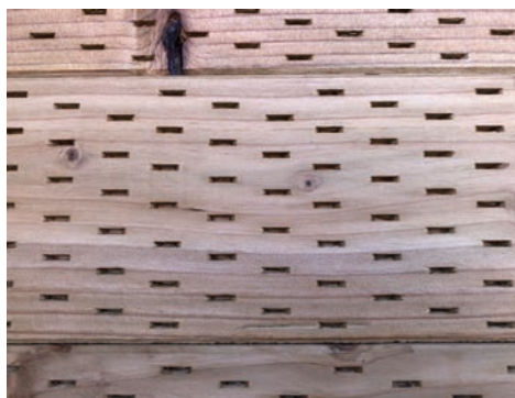
写真15-7 インサイジングを施した材面
