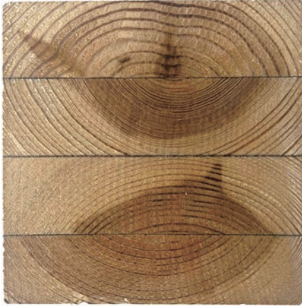
写真15-5 集成材の断面 (兼松サステック (株) 手塚大介氏提供)
