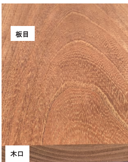
写真15-2 ケヤキの木口面と（下部）と板目面（上部）
