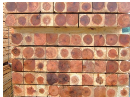
写真12-3 スギ製材品の木口面 (辺心材境界の白色部は心材への移行材部)
