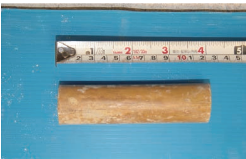
図5 セパレータ（竹製、L=12cm 壁躯体）
