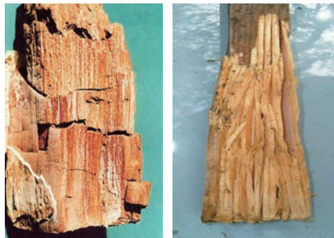
写真3-3 褐色腐朽(左)と白色腐朽(右)
