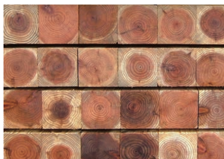
写真1-3 人工乾燥時に積み重ねられたスギ製材品の木口断面
