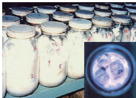
写真2-1 JIS K 1571に規定されている室内防腐試験の様子
