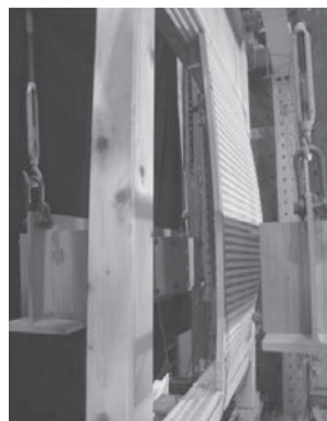
図12 舞良戸の面外座屈 (試験体B -1/15rad)
