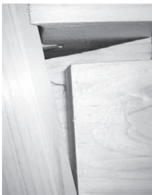
図11 足固ほぞの折損 (試験体B +1/9rad)
