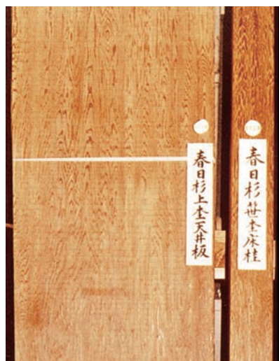
写真15-3 笹杓が現われた春日杉の天井板（左）と床柱（右）
